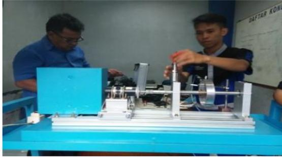
Gambar 1. 1 Alat peraga identifikasi getaran *single plane* (*rotor*)
