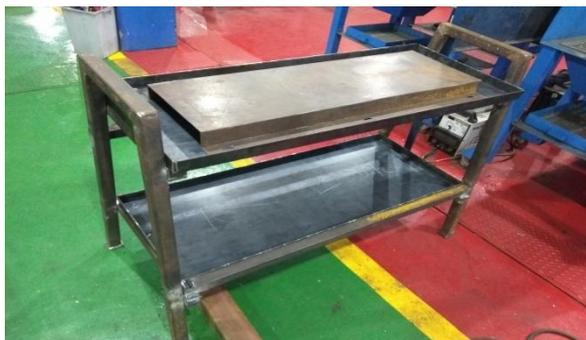
Gambar 4. 13 Hasil *assembly* pada rangka, meja alat dan dudukan buku
