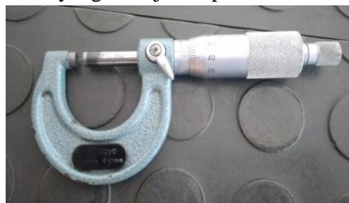
Gambar 3. 13 Mikrometer luar
