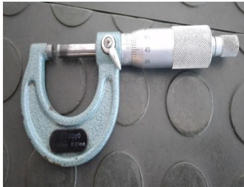
Gambar 2. 4 Mikrometer
