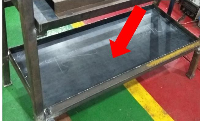
Gambar 4. 4 Hasil pelipatan plat meja alat bagian bawah
