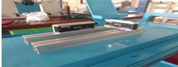
Gambar 3. 7 Posisi penempatan *ruler level meter digital*
