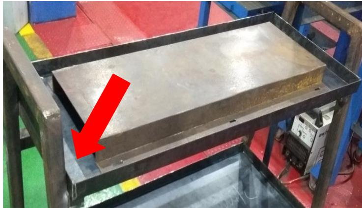
Gambar 4. 6 Hasil pelipatan plat meja alat bagian atas
