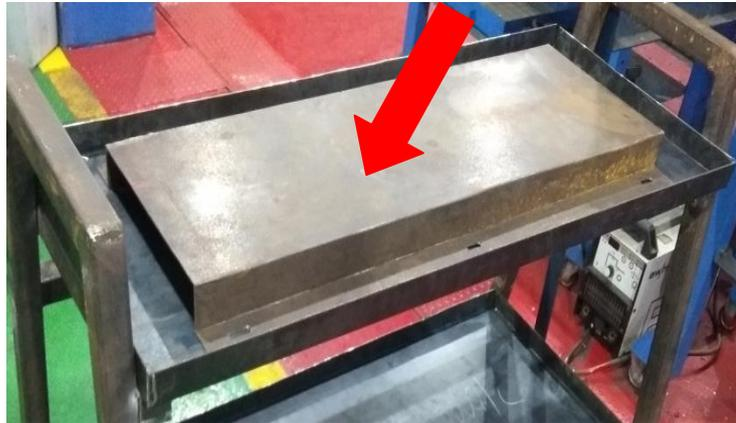
Gambar 4. 8 Hasil pelipatan plat meja alat bagian dudukan alat
