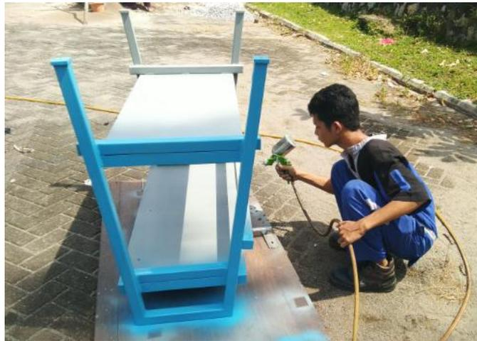
Gambar 3. 5 Proses *finishing* (pengecatan)
