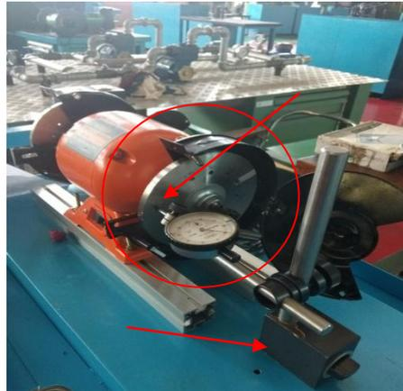
Gambar 3. 12 Pemasangan dial indikator pada titik yang akan diuji
