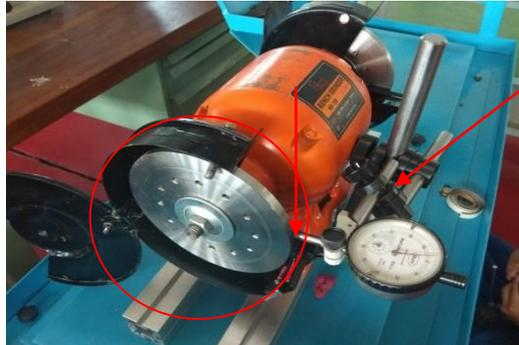
Gambar 3. 10 Pemasangan dial indikator pada titik yang akan diuji
