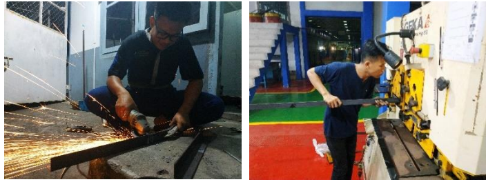
Gambar 4. 10. Pemotongan Besi Profil L
