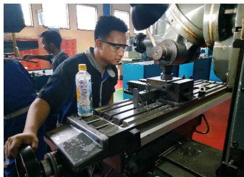
Gambar 4. 14. Proses pembuatan alur lubang pengunci dengan milling
