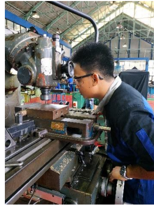
Gambar 4. 11. Pembuatan alur dengan mesin milling
