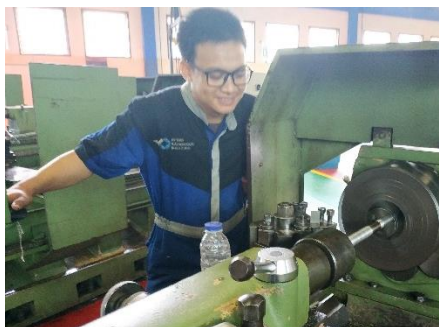
Gambar 4. 13. Proses Bubut pada Poros Utama
