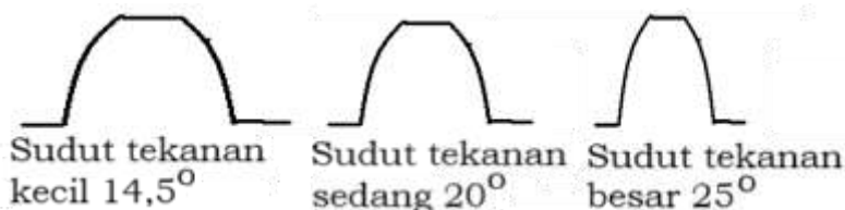
Gambar 7. Besaran atau ukuran sudut tekanan modul
