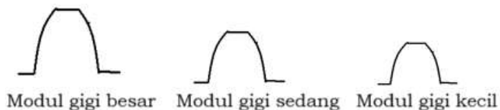
Gambar 6. Besaran atau ukuran modul
