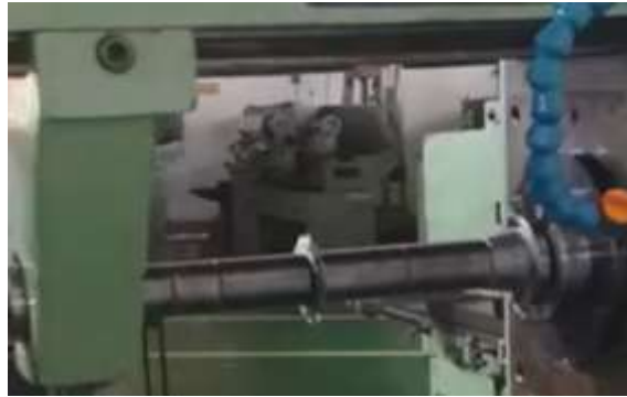
Gambar 16 Pemasangan Pisau Frais
