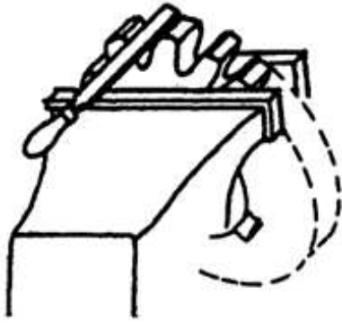
Gambar 20. Penghilangan bagian-bagian yang tajam ( debured )
