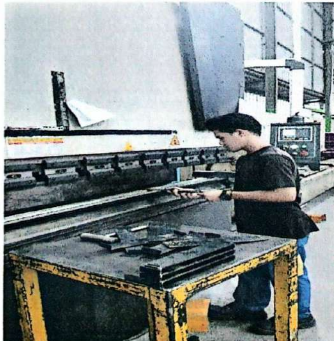
Gambar 1.6 Mesin Bending Plat
