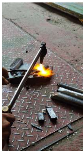
Gambar 2. 3 Proses pembuatan mata pahat bubut
