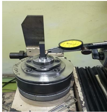
Gambar 2.8 Proses dial punch serta mencari offset
