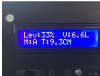
Gambar 4.37 Pengujian Perintah “Auto”
