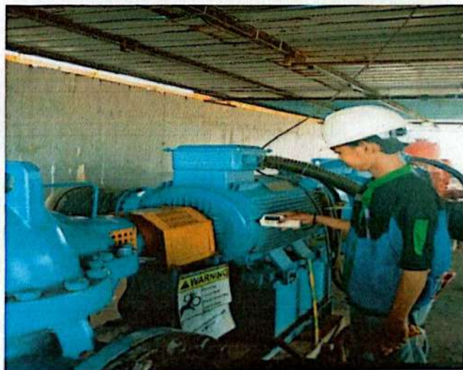
Gambar 2.7 Kegiatan pengambilan vibrasi
