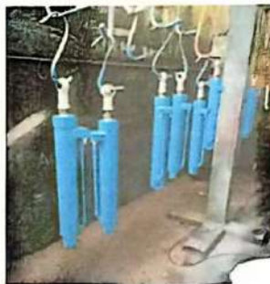
Gambar 2.3 Hasil Pengecatan Wingbox
