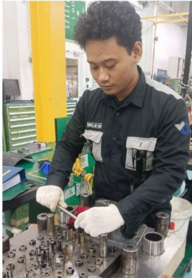
Gambar 2.5 Melepas Baut Pada Kei
