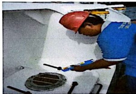
Gambar 2. 11 Penulis Melakukan Kegiatan Mengaplikasikan Silikon Putih Pada Bull's Eye Kapal Tunda ( Tug Boat ) HBI 05.
