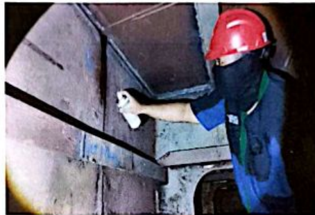
Gambar 2. 3 Penulis Melakukan Kegiatan Penetrant Test Pada Tangki Void Kapal Tongkang ( Oil Barge ) FOTB 05.
