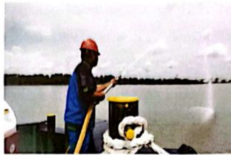
Gambar 2. 23 Penulis Melakukan Kegiatan House Test Pada Kapal Tunda (Tug Boat) MBP 161.
