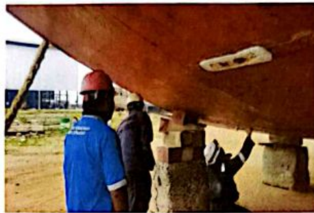
Gambar 2. 12 Penulis Melakukan Kegiatan UTM Pada Bagian Lambung Kapal Tongkang ( Oil Barge ).
