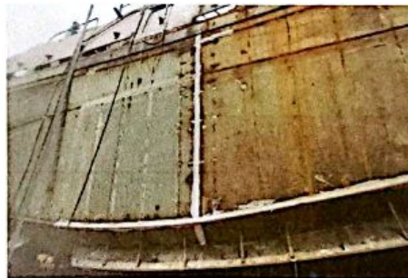
Gambar 2. 22 Penulis Melakukan Kegiatan Camphor Test/Chalk Test Pada Kapal Tunda ( Tug Boat ) Milik PT. Pahala Harapan Lestari.
