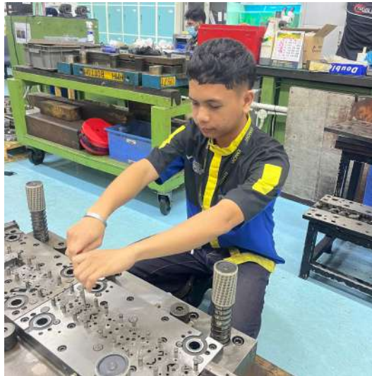
Gambar 2.1 proses pengecekan Die Insert
