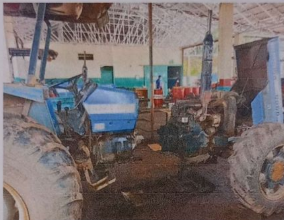
Gambar 2. 13 Ganti kopling traktor landini 8860
