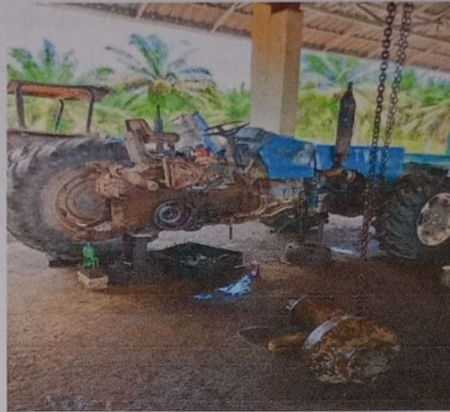
Gambar 2. 3 Ganti kampas rem traktor landini 8860
