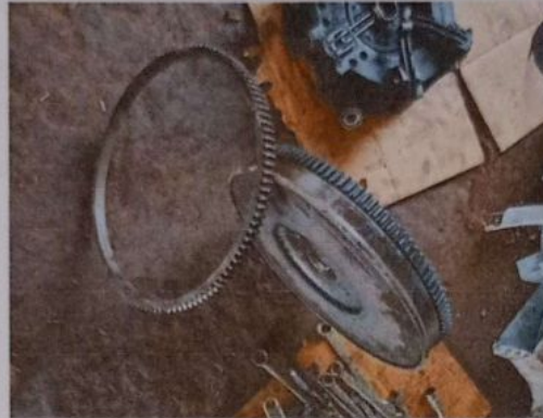
Gambar 2. 11 Ganti ring gear traktor landini 8860
