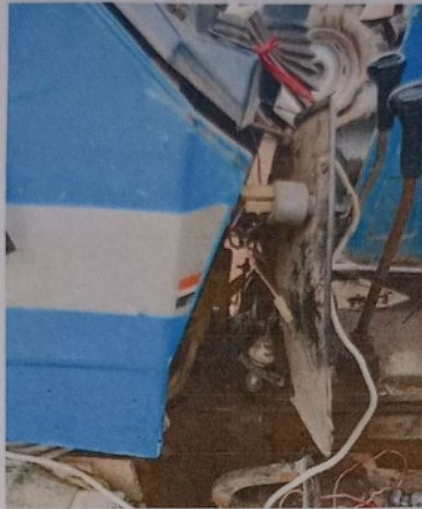
Gambar 2. 21 Pebaiki perkabelan traktor landini 8860
