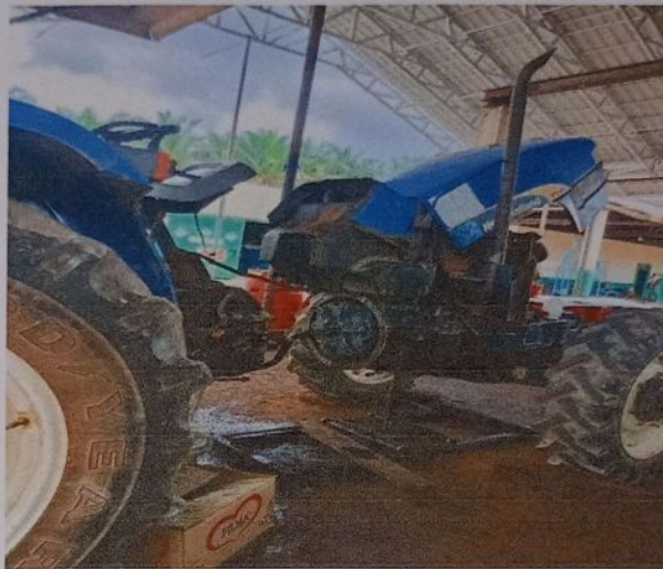
Gambar 2. 2 Ganti kopling traktor New Holland TT45
