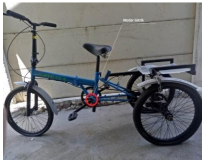
Gambar 4.4 Motor Listrik dengan Transmisi ke Roda
