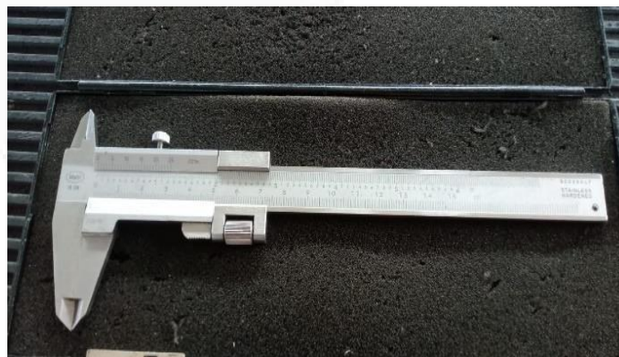
Gambar 3. 3 Jangka Sorong Kecermatan 0,02 mm
