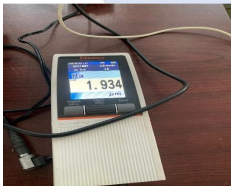
Gambar 3. 6 Surface Raogness Tester Kecermatan 0,5 mm/s
