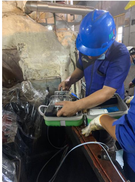
Gambar 2.9 Pengujian dan Pengkalaribasian Sensor Vibrasi
