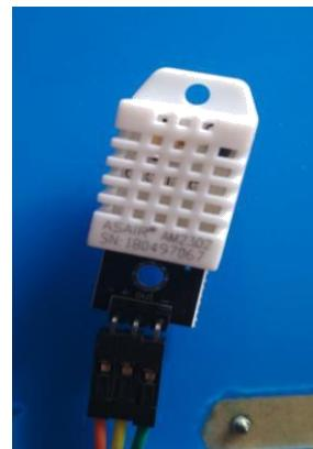
Gambar 4.18 Sensor DHT 22
