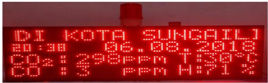
Gambar 4.38 Tampilan pada *LED* Dot Matrix saat Udara Bersih
