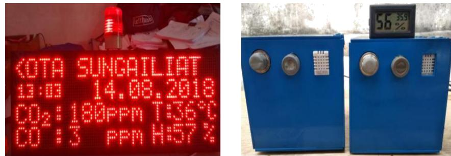
Gambar 4.21 Perbandingan box sensor dengan alat ukur pukul 13:02
