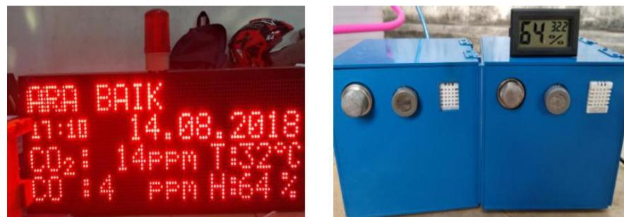
Gambar 4.22 Perbandingan box sensor dengan alat ukur pukul 17:10
