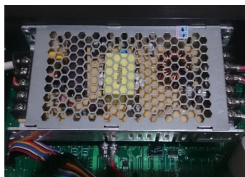
Gambar 4.9 *Power Supply Switching* yang digunakan sebagai catu daya
