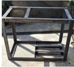
Gambar 4.7 Rangka Mesin Pencacah (Dokumentasi Pribadi)
