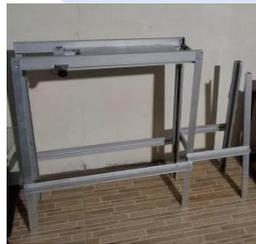
Gambar 4.11 Rangka Mesin Penyortir (Dokumentasi Pribadi)
