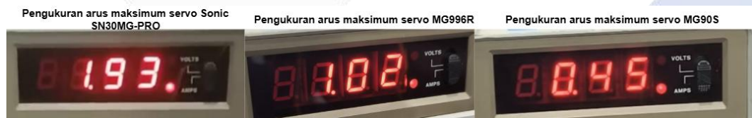
Gambar 3.22 Hasil pengukuran arus maksimum servo
