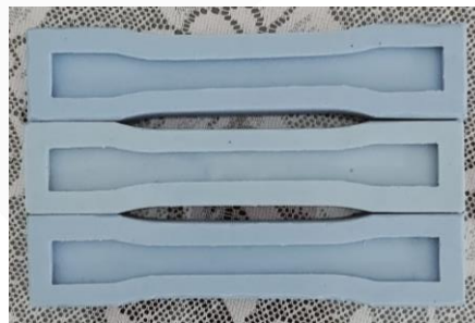
Gambar 3.7 Cetakan standar ASTM-638
