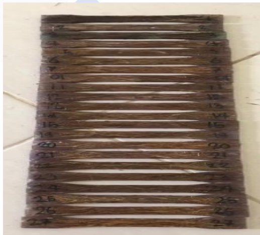
Gambar 4.7 Spesimen ASTM D-638
