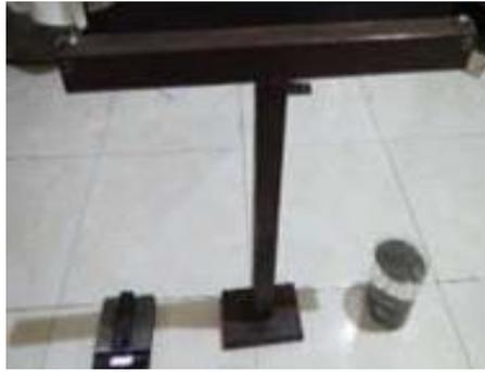
Gambar 3. 15 Alat uji densitas
