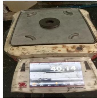
Gambar 4. 7 Proses pengujian densitas pada sampel
