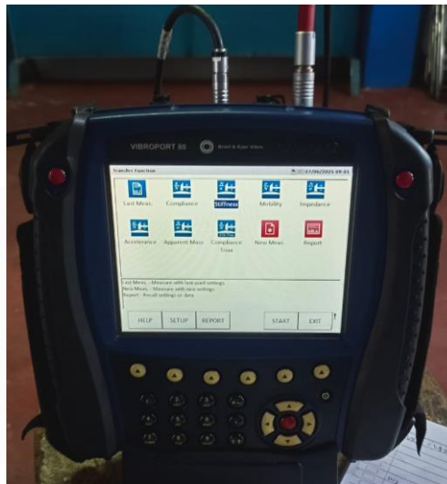
Gambar 3. 3 Alat Uji Vibroport 80
