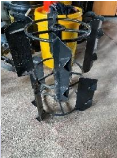
Gambar 4.7 Paddy Wheel pada Mesin
