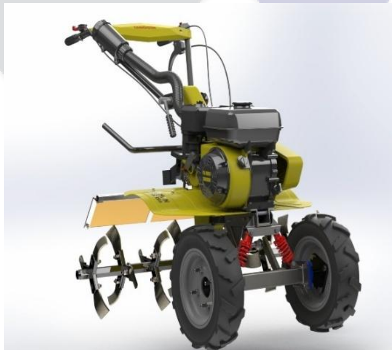
Gambar 4.42 Mesin Cultivator yang telah Dikembangkan
