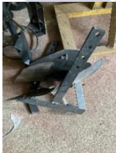
Gambar 4.8 Mata Pisau Moldboard pada Mesin
