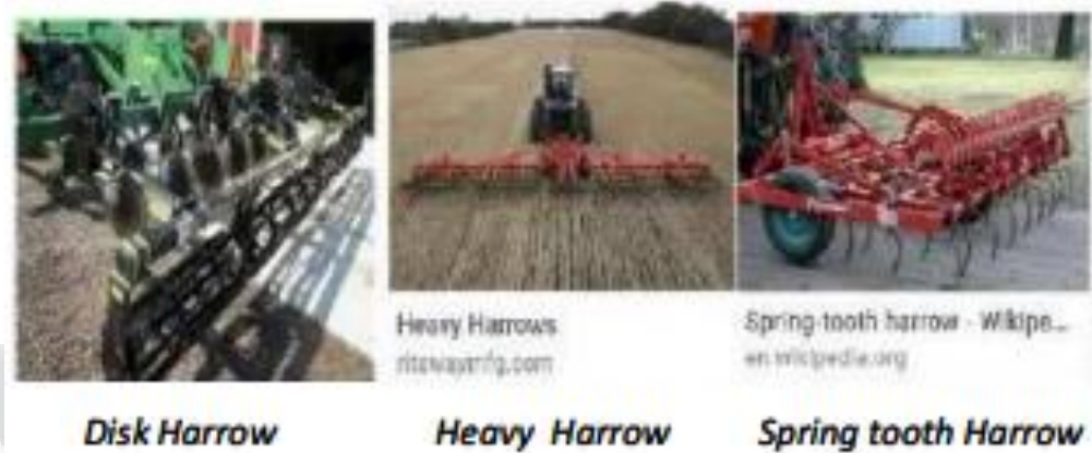
Gambar 2.6 Alat Pengolahan Tanah Sekunder (Hartono & Wibowo, 2018)
