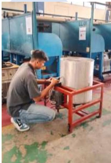
**Gambar 4.3** Pengukuran Getaran awal menggunakan *vibrometer*
