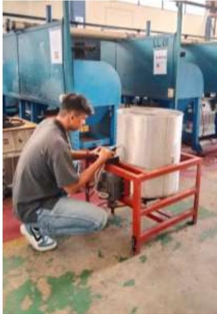
6. Melakukan Alignment *pulley*
