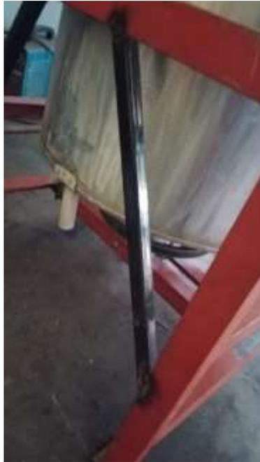
**Gambar 4.12** Penambahan kerangka pada mesin
