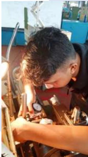
**Gambar 4.5** Pengukuran kebulatan dan ketegaklurusan
