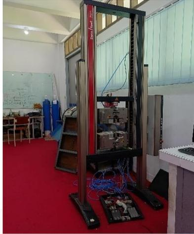
Gambar 3. 9 Mesin uji bending Zwick Roell Z020
