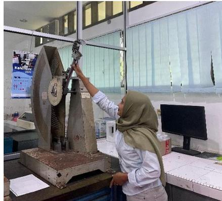
Gambar 4. 2 Pengujian Impak
