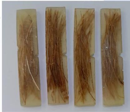
Gambar 4. 1 Spesimen Impact
