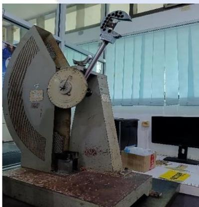
Gambar 3. 8 Alat uji impak
