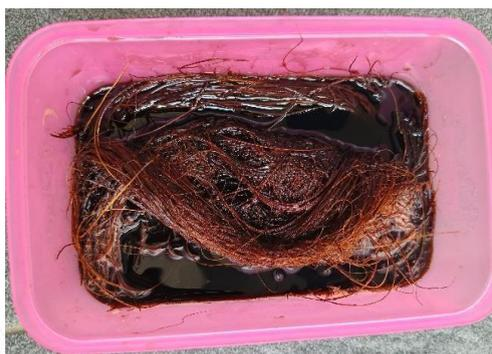
Gambar 2. 5 Perendaman Serat Kelapa Menggunakan NaOH
