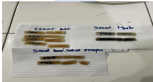
Gambar 4.7 Sampel Setelah Dilakukan Uji Impak
