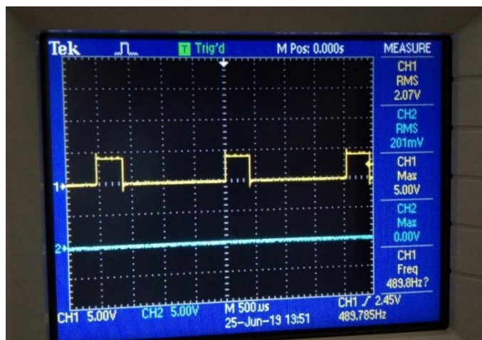
Gambar 4. 6 Gelombang PWM Vout Driver dengan duty cycle 41,4%
