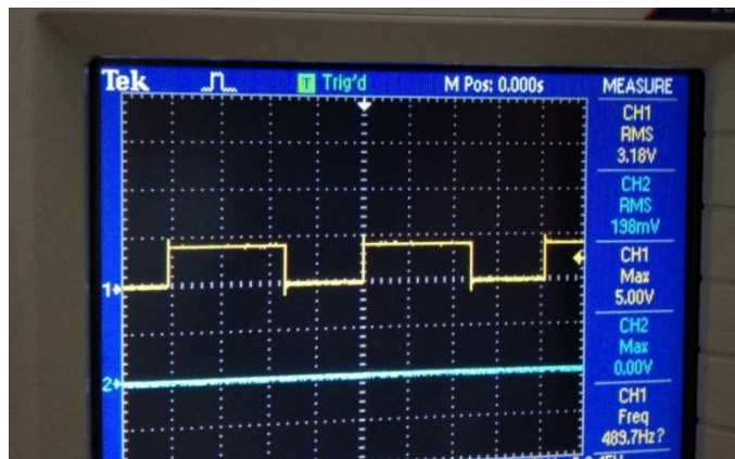
Gambar 4. 8 Gelombang PWM V_{out} driver dengan duty cycle 63,6%
