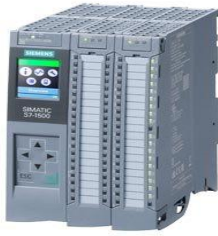
Gambar 1. 5 Simatic S7-1500 & Module I/O
