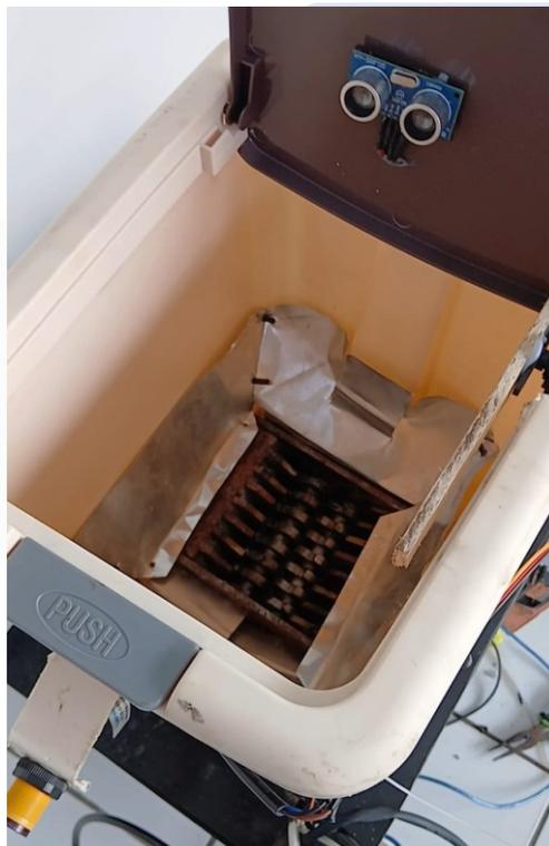
Gambar 4.7 Gambar posisi mata pisau shredder dan sensor ultrasonik 1
