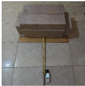
Gambar 4.2 Proses Uji Peredaman Suara
