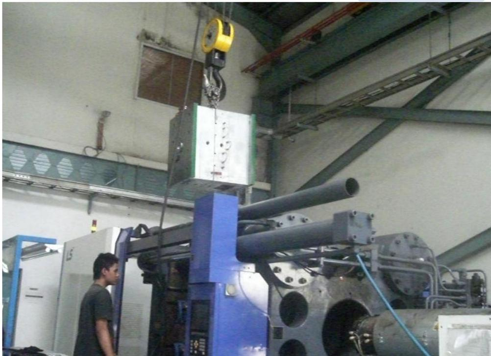
Gambar 1.1 Proses Pemasangan Cetakan
