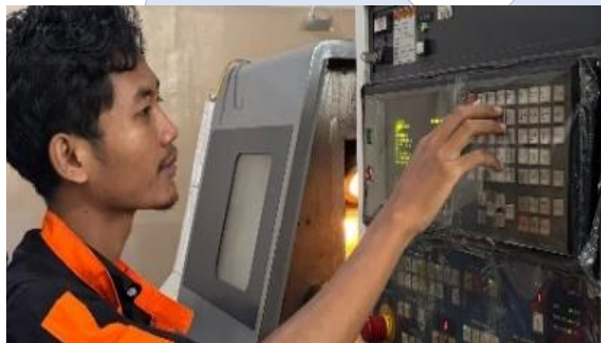
Gambar 4. 1 Proses Memasukan Program Pada Mesin CNC Bubut
