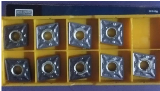
Gambar 3. 3 Insert Carbide Type CNMG 120408-MA
