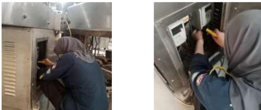
*Gambar 2. 3 Pengantian inverter mesin ekstruder*
