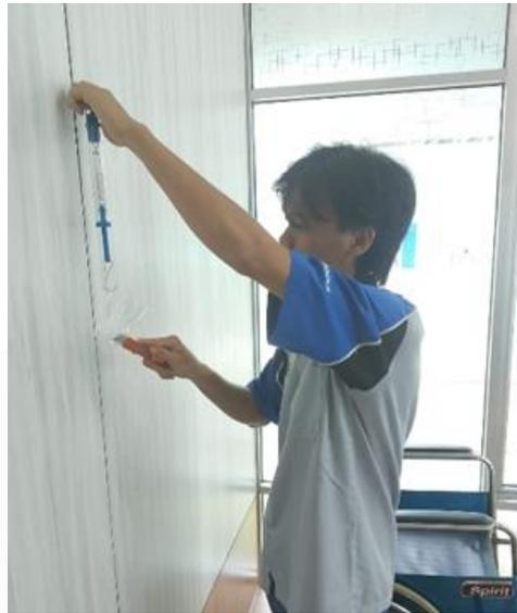
Gambar 4. 1 Uji Cup Plastik Menggunakan Neraca Pegas
