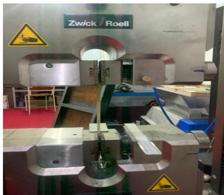
Gambar 4. 1 Proses Pengujian Tarik
