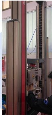
Gambar 3. 10 Mesin uji tarik
