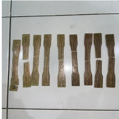
Gambar 4. 2 Spesimen Hasil Uji Tarik
