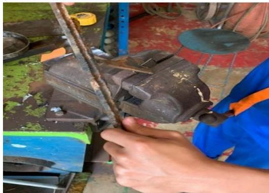
Gambar 4. 11 Pembengkokkan *Blade Impeller*
