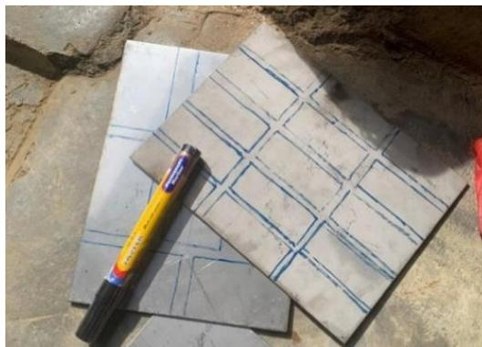
Gambar 4. 1 *Marking blade inlet dan outlet*
