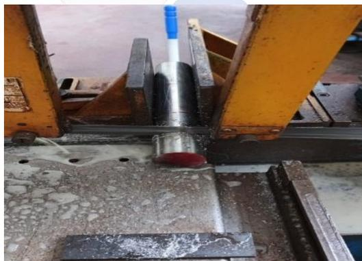
Gambar 4. 3 Pemotongan *Shaft Stainless*
