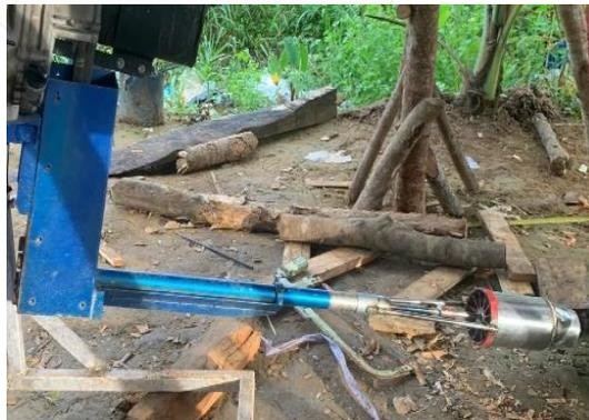
Gambar 4. 21 *Waterjet Thruster* pada mesin uji
