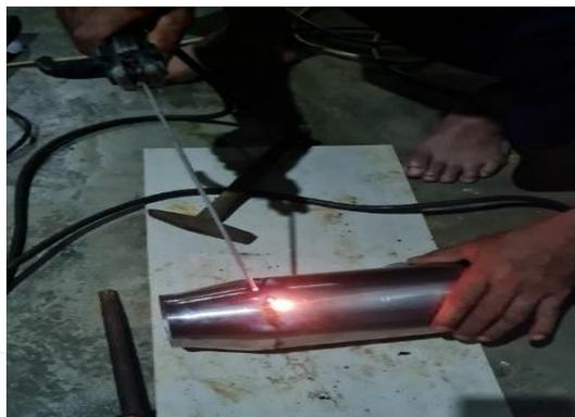
Gambar 4. 19 Pengelasan *Nozzle*
