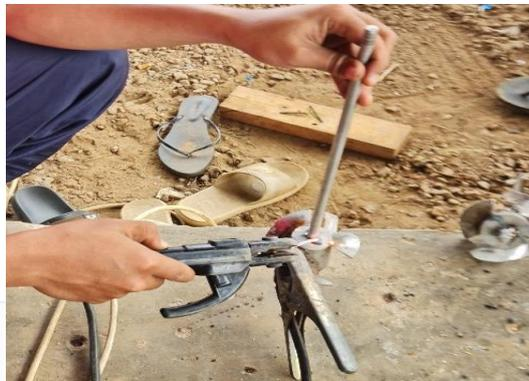
Gambar 4. 16 Pengelasan *Shaft Impeller*
