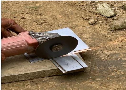
Gambar 4. 5 Pemotongan *Blade Outlet*
