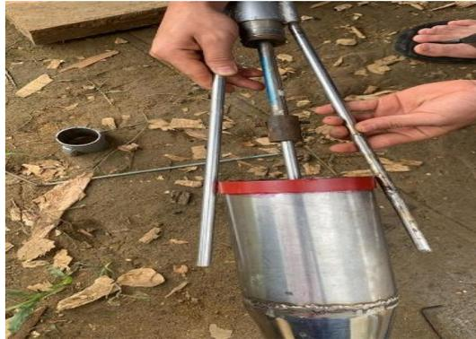
Gambar 4. 20 Pengikatan *Waterjet* Ke Mesin Uji
