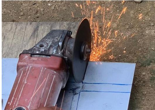
Gambar 4. 6 Pemotongan *Blade Inlet*
