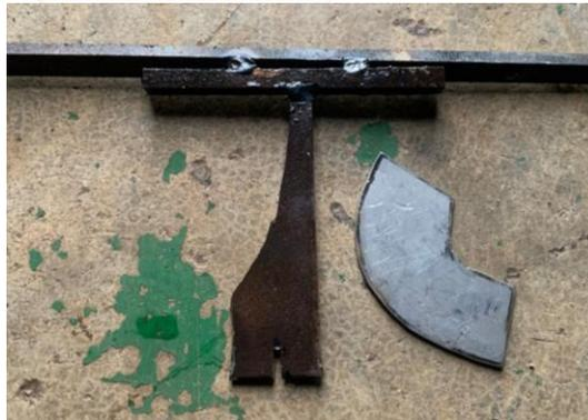
Gambar 3. 20 Alat Penekuk *Impeller*
