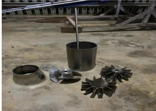
Gambar 4. 14 Komponen Hasil *Waterjet Thruster*
