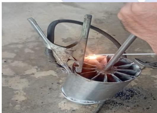
Gambar 4. 18 Pemasangan *Inlet Turbo* pada Selongsong
