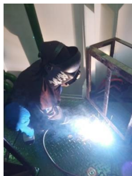
Gambar 2.5 Pengelasan Siku-Siku Besi
