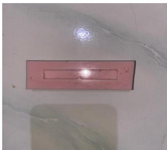
Gambar 3. 2 Cetakan Uji Bending
