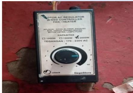
Gambar 2. 4 Pengontrol kecepatan (*Dimmer*)
