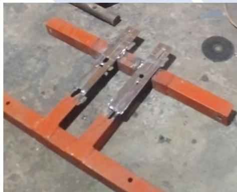
Gambar 4. 3 Pengubahan Rangka Motor Penggerak
