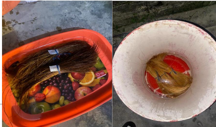
Gambar 3.13 Perndaman serat dalam campurab NaOH
