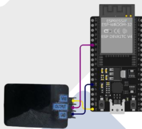
Gambar 4.9 Skematik Rangkaian Hardware Sensor Konduktivitas
