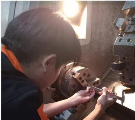
Gambar 4. 3 Pemasangan Benda Kerja
