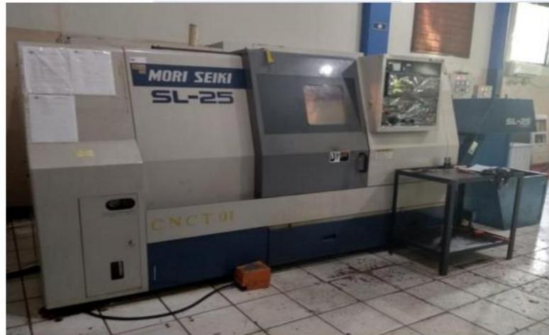
Gambar 3. 2 Mesin Bubut CNC MORI SEIKI SL-25
