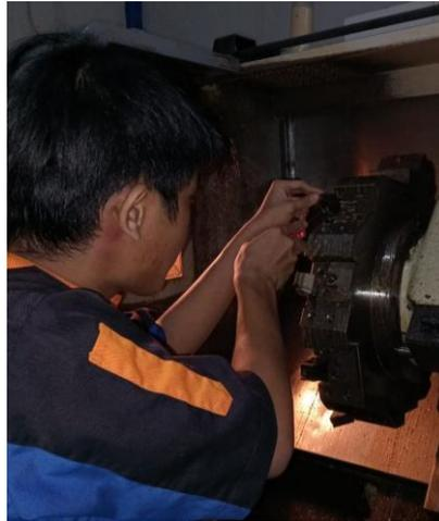
Gambar 4. 4 Pemasangan Alat Potong
