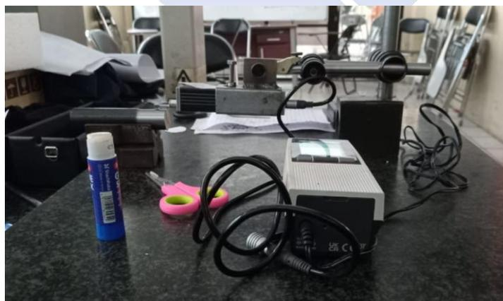
Gambar 4. 12 Proses Pengukuran Kekasaran Permukaan Benda Kerja
