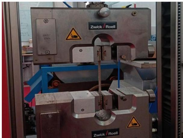
Gambar 4.1 Proses Pengujian Kuat Tarik.
