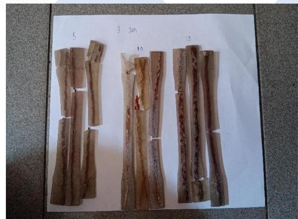
10. Spesimen uji bending yang telah di uji
