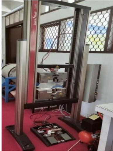
Gambar 3.12 Mesin Uji Tarik dan *bending* (Zwick Roell)
