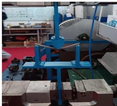
Gambar 4.4Proses Pengujian *Bending*
