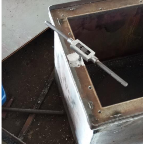
Gambar 2.6 Proses Pengetapan Lubang Baut
