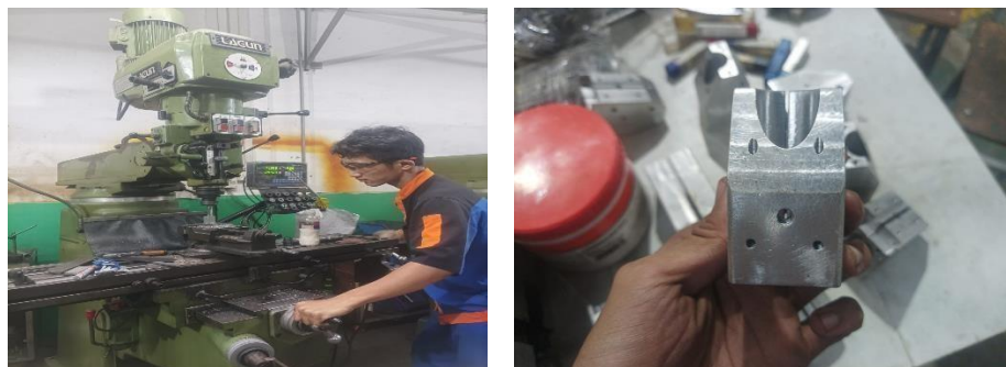
Gambar 2.5 Proses Pengeboran Lubang Baut untuk kamera housing
