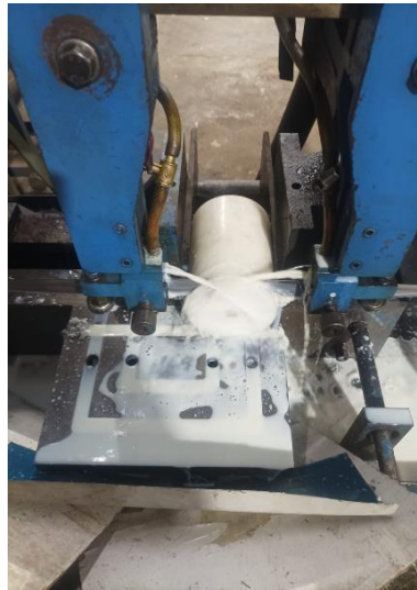
Gambar 2.3 Pemotongan Cartridge Filter untuk penahan pipa
