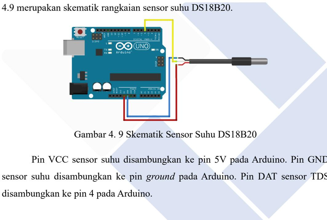
Gambar 4. 9 Skematik Sensor Suhu DS18B20
