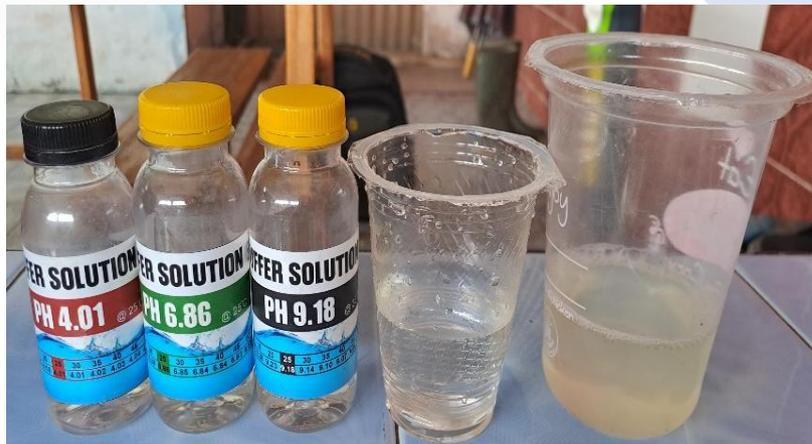
Gambar 4. 4 Sampel Larutan Pengujian Sensor pH 4502C
