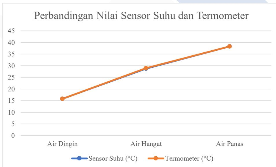
Gambar 4. 10 Grafik Perbandingan Nilai Sensor Suhu dan Termometer
