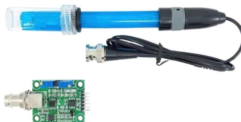
Gambar 2. 6 Sensor pH 4502C
