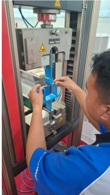
Gambar 4.10 Proses Pengujian Bending
