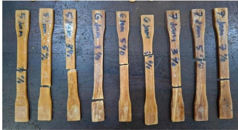
Gambar 4. 3 Spesimen Setelah Dilakukan Uji Tarik
