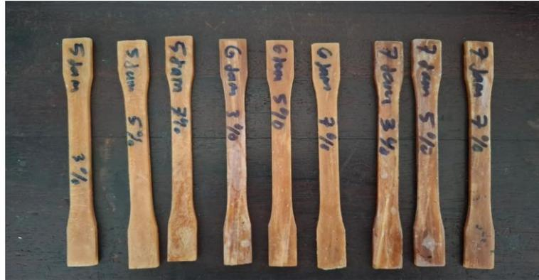
Gambar 4. 1 Spesimen Uji Tarik
