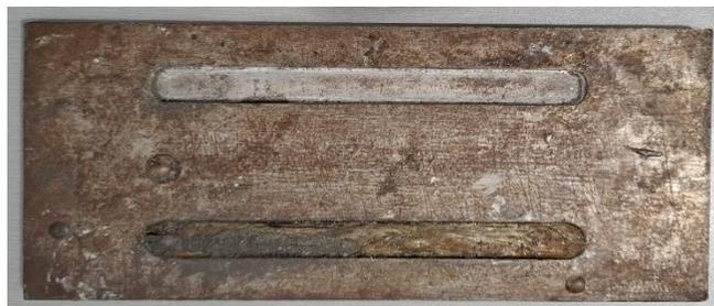
Gambar 3.7 cetakan uji bending
