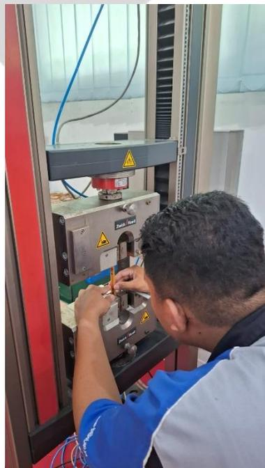
Gambar 4. 2 Proses Pengujian Tarik
