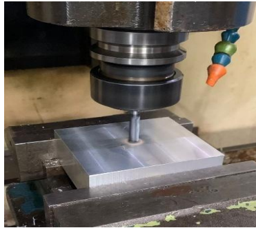
Gambar 4. 28 Proses Penyetingan titik nol Z (H)
