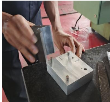
Gambar 4. 55 Proses pemasangan pin di Core cetakan
