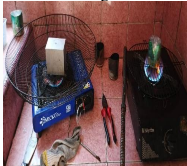
Gambar 4. 60 Proses pencairan material plastik PET dan pemanasan cetakan
