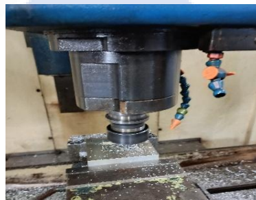
Gambar 4. 33 Proses pemesinan Profil 1 menggunakan End Mill 4 mm
