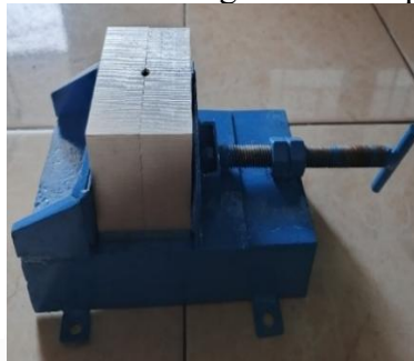
Gambar 4. 59 Pemasangan cetakan di Ragum
