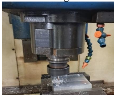
Gambar 4. 47 Proses pemakanan pembuangan Core
