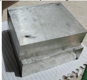
Gambar 4. 23 Hasil akhir pemotongan menggunakan mesin gergaji potong DoAL C-916
