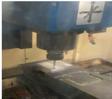
Gambar 4. 30 Proses pemakanan Pocket 1 (Roughing)
