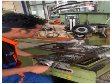
Gambar 4. 24 Proses pemotongan sisi di Milling Fehلمان P18s
