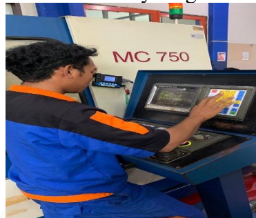
Gambar 4. 29 pemindahan File G-Code dari Flasdisk menggunakan DNC Device
