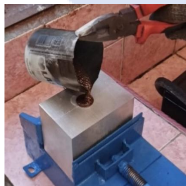
Gambar 4. 61 Penuangan material langsung ke cetakan
