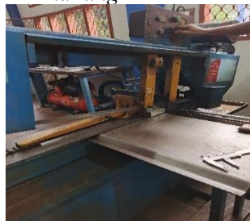
Gambar 4. 21 Proses pemotongan benda kerja menggunakan Mesin Gergaji DoAL C-916
