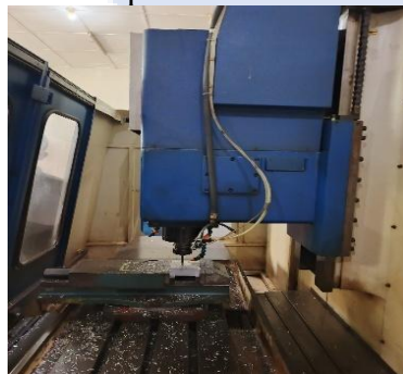
Gambar 4. 31 Proses pemakanan 1 (Contour) Finishing
