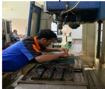
Gambar 4. 41 Proses pengecekan dimensi setelah dilakukan proses manufaktur
