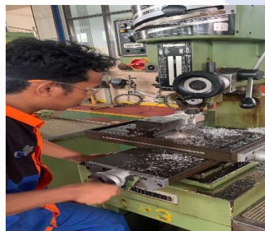
Gambar 4. 51 Finishing ukuran bakal di Mesin milling Fehlman P18s
