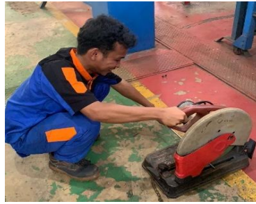
Gambar 4. 52 Pemotongan pin menggunakan mesin gerinda
