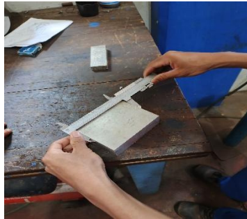
Gambar 4. 22 Proses pengukuran hasil pemotongan menggunakan Jangka Sorong
