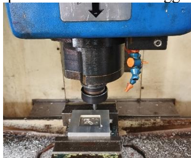
Gambar 4. 34 Proses pemesinan Profil 1 menggunakan Single Lips 90 derajat
