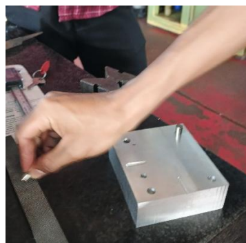
Gambar 4. 54 Proses pengikisan pada pin sebelum di assembly
