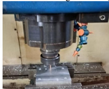
Gambar 4. 49 Proses pemakanan Runner Core
