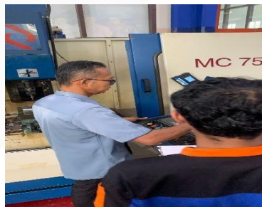
Gambar 4. 26 Penyetingan titik nol X dan Y Cavity
