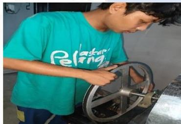
Gambar 4.14 Proses Pemasangan *Pulley* dan *V-Belt*
