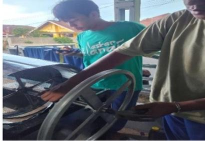
Gambar 4.10 Proses Pemasangan *Pulley* Pada Poros
