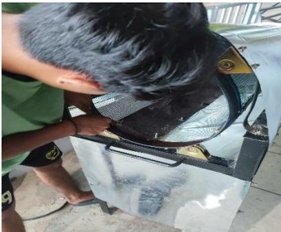
Gambar 4.8 Proses Pemasangan Jaringan Pasir
