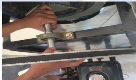
Gambar 4.12 Proses Pemasangan Poros Utama
