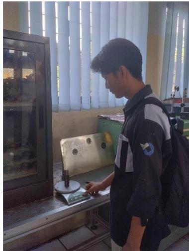
Gambar 3. 13 Mengukur Berat Spesimen Uji
