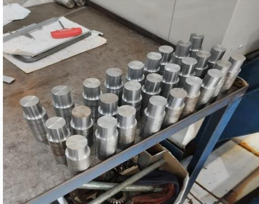
Gambar 3. 9 Spesimen Uji Hasil CNC Bubut
