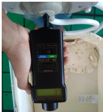
Gambar 4. 52 Hasil Pengukuran Rpm Ayunan Dengan Beban Keadaan Pelan
