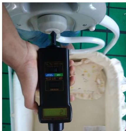
Gambar 4. 60 Hasil Pengukuran Rpm Ayunan Dengan Beban Suara Pelan
