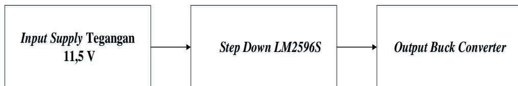
Gambar 4. 70 Blok Pengujian Step Down LM2596
