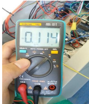
Gambar 4. 77 Hasil Pengukuran Arus pada Resisitansi 100 Ohm
