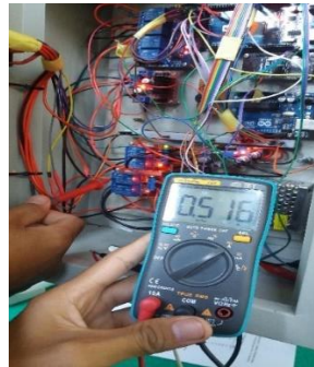
Gambar 4. 82 Hasil Pengukuran Arus Output Total Pada Rangkaian
