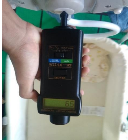
Gambar 4. 44 Hasil Pengukuran Rpm pada Saat Ayunan Keadaan Sedang
