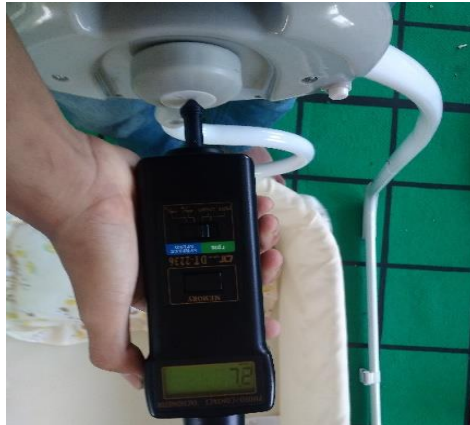
Gambar 4. 42 Hasil Pengukuran Rpm pada Saat Ayunan Keadaan Cepat
