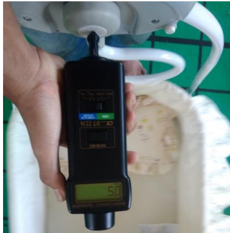
Gambar 4. 46 Hasil Pengukuran Rpm pada Saat Ayunan Keadaan Pelan
