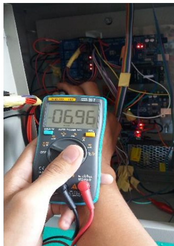
Gambar 4. 64 Hasil Pengukuran Tegangan pada Saat PWM 255
