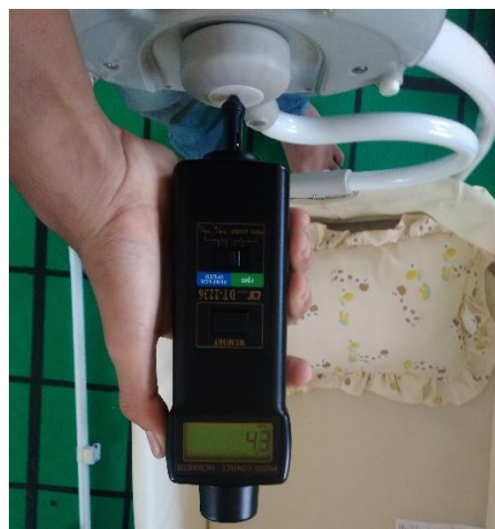
Gambar 4. 50 Hasil Pengukuran Rpm Ayunan Dengan Beban Keadaan Sedang
