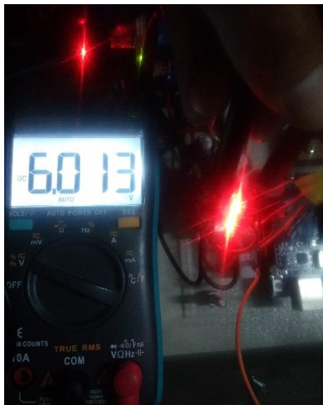
Gambar 4. 72 Hasil Pengukuran Tegangan Output Saat Input Dari 6 V
