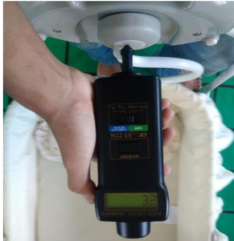
Gambar 4. 57 Hasil Pengukuran Rpm Ayunan Dengan Beban Suara Sedang
