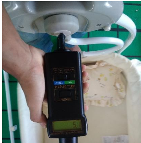
Gambar 4. 54 Hasil Pengukuran Rpm Ayunan Dengan Beban Suara Keras
